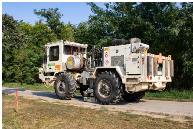
Ilyen önjáró vibrátor járműveket láthat majd a kutatási területen
